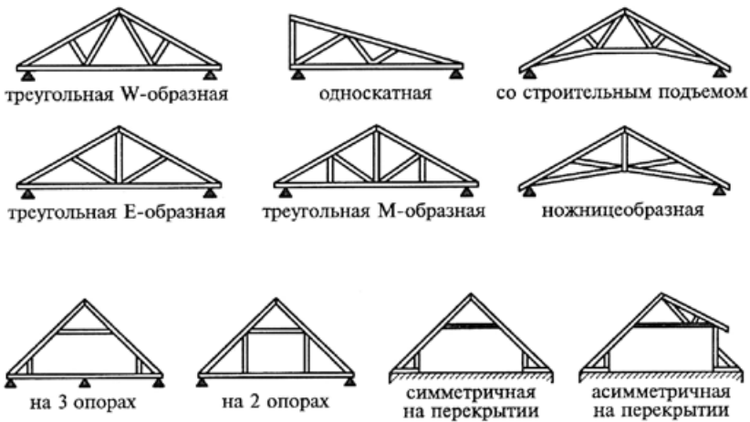
Рис. 11.3. Очертания стропильных ферм для скатных кровель
