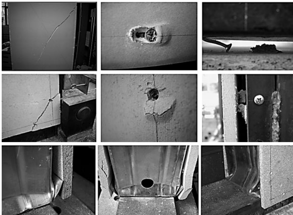
Рис. 7.5. Формы отказов (разрушений) обшивки стеновой панели при восприятии сдвигающих усилий: 1 — трещины в обшивке; 2 — смятие обшивки саморезом; 3 — смятие каркаса КОС саморезом; смятие металла более чем два диаметра самореза и саморез выпал из каркаса; 4 — отрыв обшивки через головку самореза
