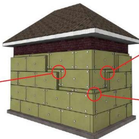
Устройство смещения второго слоя утеплителя
